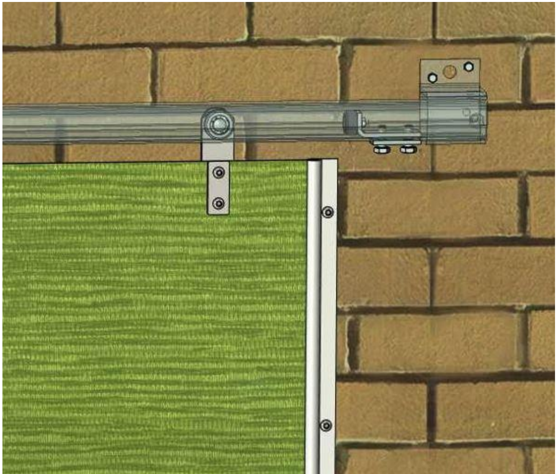
Abb. 8 (Aluminium-Kederschiene mit Dübel am Mauerwerk, Schraubabstand ca. 50 cm)
