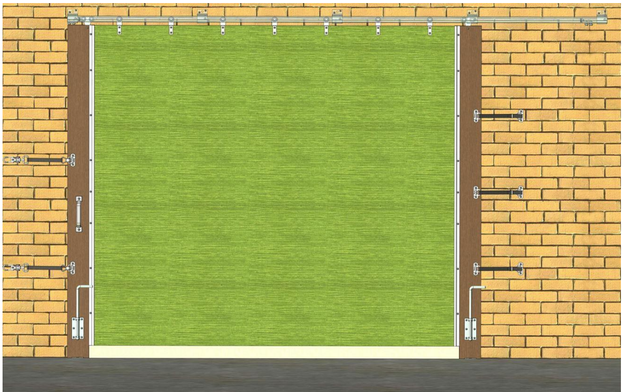
Abb. 11 linke Seite - untere Ratsche ca. 60-70 cm über Boden – obere in Kopfhöhe!
