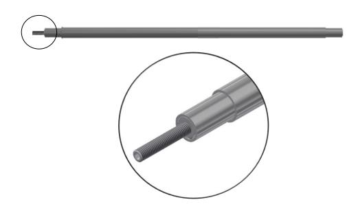
5x "Längsrohr 1375mm" auf geschlossener Gewinde Seite "Gewindestift M10x60" bis zum Anschlag einschrauben
