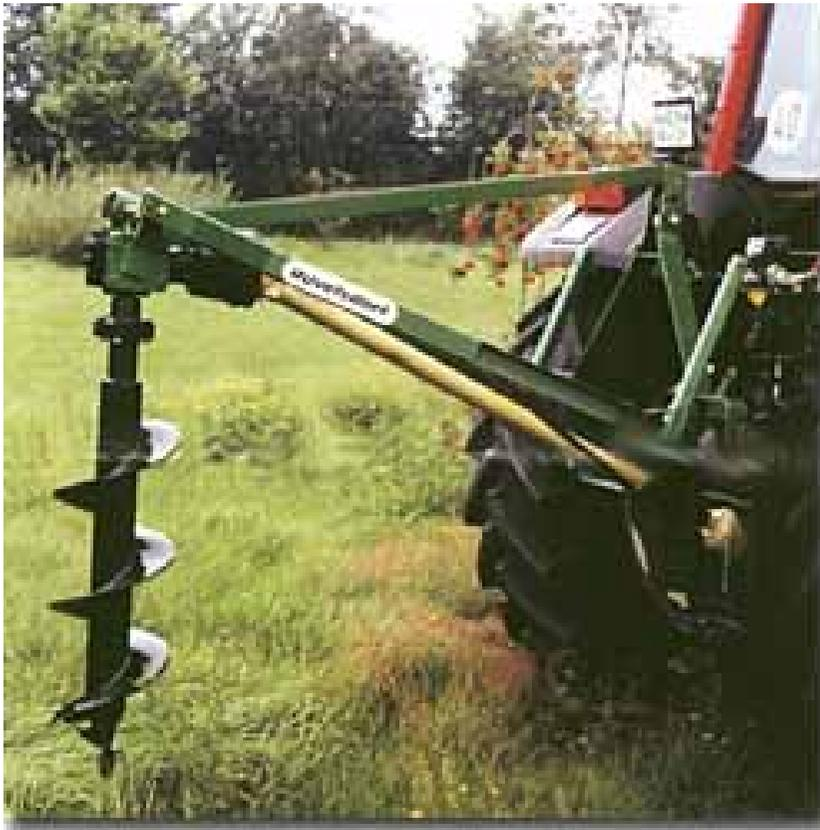
Der stabile Erdborher wird standardmäßig mit 300 mm Bohrspindel geliefert. Alternativ ist eine 150 mm Bohrspindel lieferbar. Die Bohrspindeln sind mit auswechselbaren Schneidmessern ausgestattet. Die mitgelieferte Gelenkwelle hat eine Rutschkuppel. Sie treibt das Ölbadgetriebe an. Die Bohrtiefe beträgt 100 cm. Die Konstruktion erlaubt ein platzsparendes Abstellen und, dank der FüÙe, ein leichtes Ankoppeln an der Schlepper. Gewicht 138 kg.
